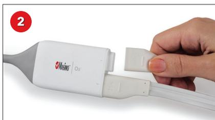
Connectez les capteurs O3 au module MOC-9 O3 (jusqu'à deux capteurs par module)
